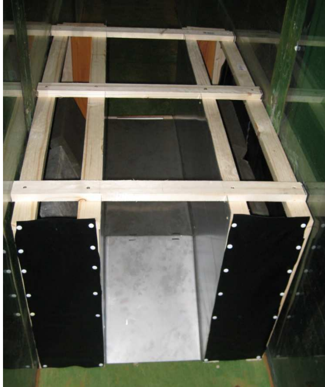
Abbildung 7: Barrierenkonstruktion, eingebaut in Kipprinne
