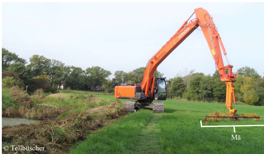
Abbildung 6. Krautungsbagger mit Mähkorb (Mä) neben abgelegtem Kraut an der Barthe bei Altenhagen, 15.10.2019.
